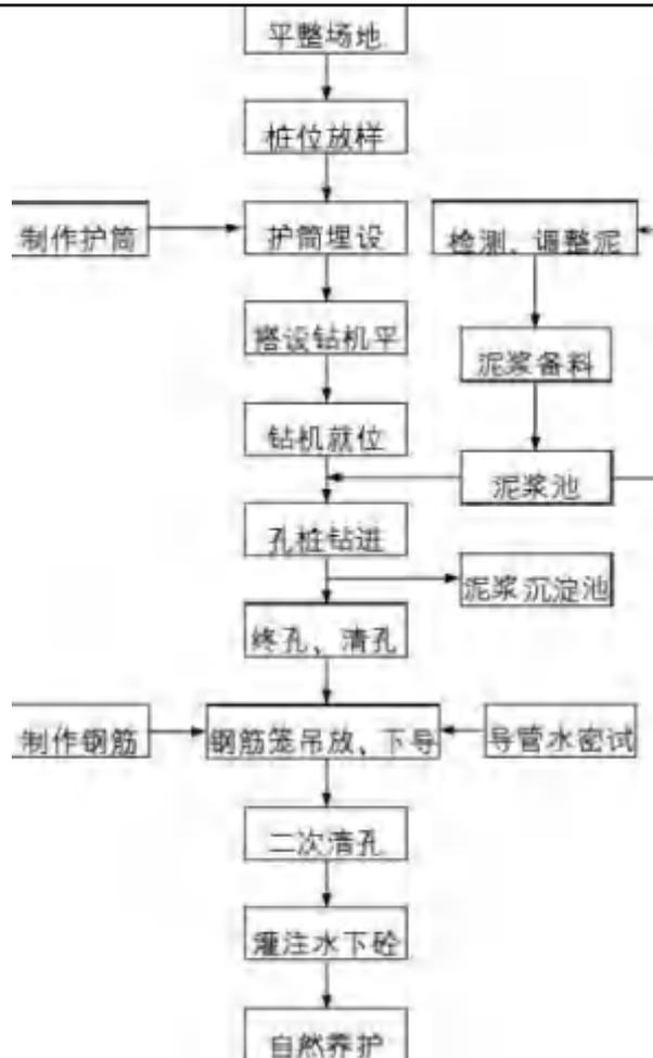
图 2-1 钻孔灌注桩施工工艺流程图
