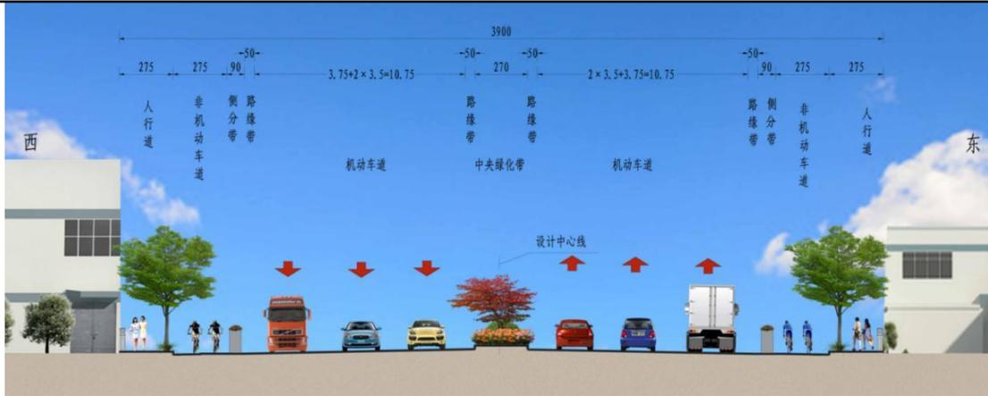
图 2-1 镇东路（江南路以南）地面道路段标准横断面图（K0+000~K2+030）
